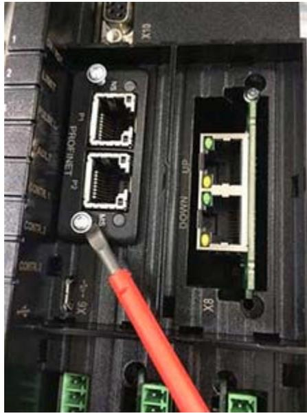
**Abbildung 5-22.** Ausbau Anybus-Modul
